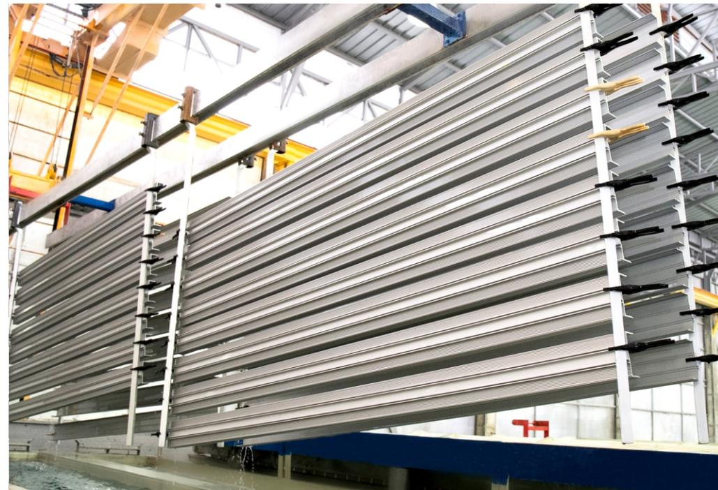
Процесс анодирования алюминиевого профиля происходит путём его погружения в ванну с раствором серной кислоты (180-200 г/л), температурой 18-20°C и подключения к положительному полюсу источника постоянного электрического тока 10-20 В.
