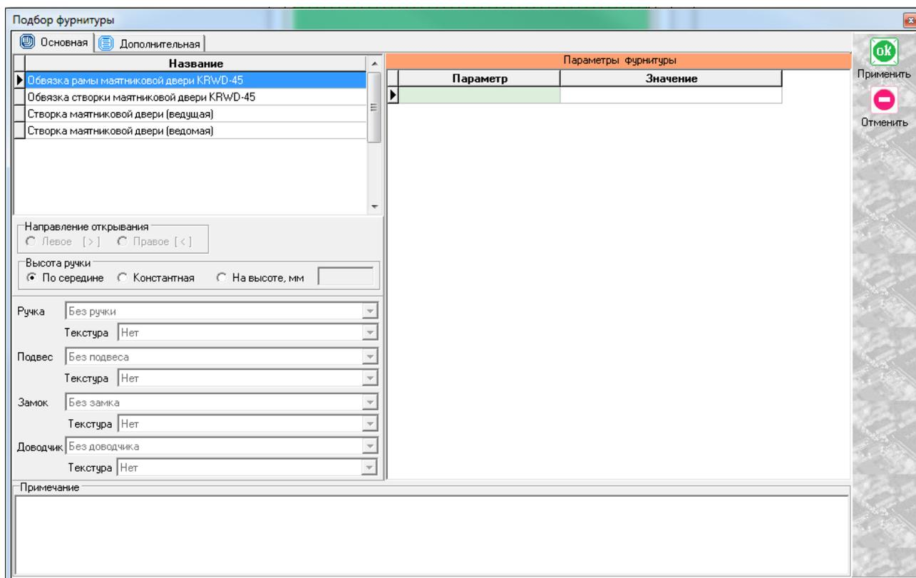
Выбираем сначала вариант «обвязка рамы маятниковой двери», после чего ждем «**ОК ПРИМЕНИТЬ**». Мы получили контур, необходимый для установки створки маятниковой двери, составленный из порога 127160 и профиля накладки 127110. Повторно нажимаем иконку
