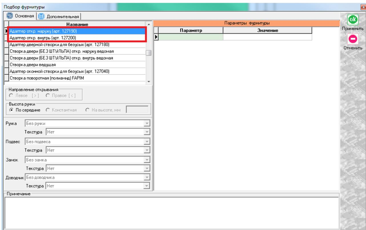
После выбора адаптера, порог установится автоматически (если необходимо, порог можно поменять вручную после установки адаптера в проем). Последующее построение двери описывалось ранее в разделах «двери наружного и внутреннего открывания». В конечном итоге рисунок (в случае двустворчатой двери) должен иметь вид:
