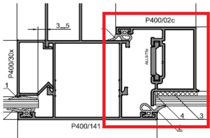
Она не имеет штапика, стекло клеивается к створке, а толщина заполнения ограничивается 5 мм.
