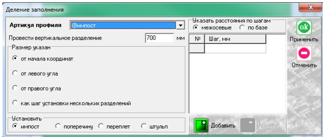
С функцией деления заполнения мы сталкивались ранее на примере горизонтального деления, таблица содержит похожие графы для заполнения, с единственным отличием – деление осуществляется вертикальной линией и отсчет размера для установки вертикального разделения происходит слева направо, от крайней левой точки до центра разделяемого элемента. Таким элементом будет 327030 – штульповой дверной профиль, что и указываем в графе «Артикул профиля». Получили конструкцию следующего вида:
