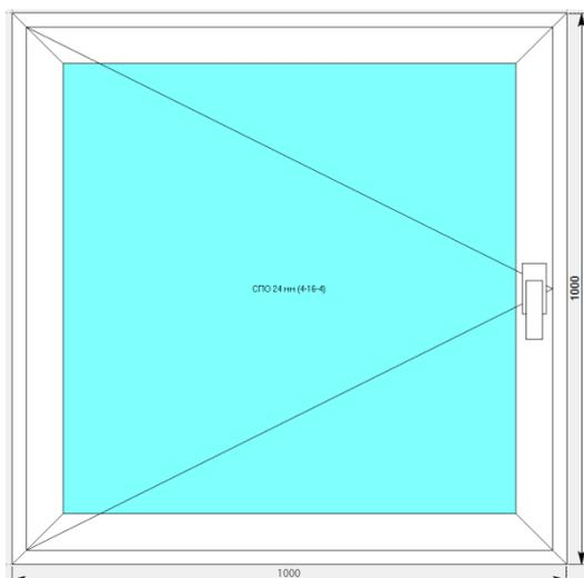
По умолчанию устанавливается створка 121060. Остается, в случае необходимости, поменять артикул створки на более усиленный через «свойства элементов». Если необходимо поменять направление открывания створки, выделяем заполнение, нажимаем правую кнопку мыши и выбираем «изменить направление открывания».
