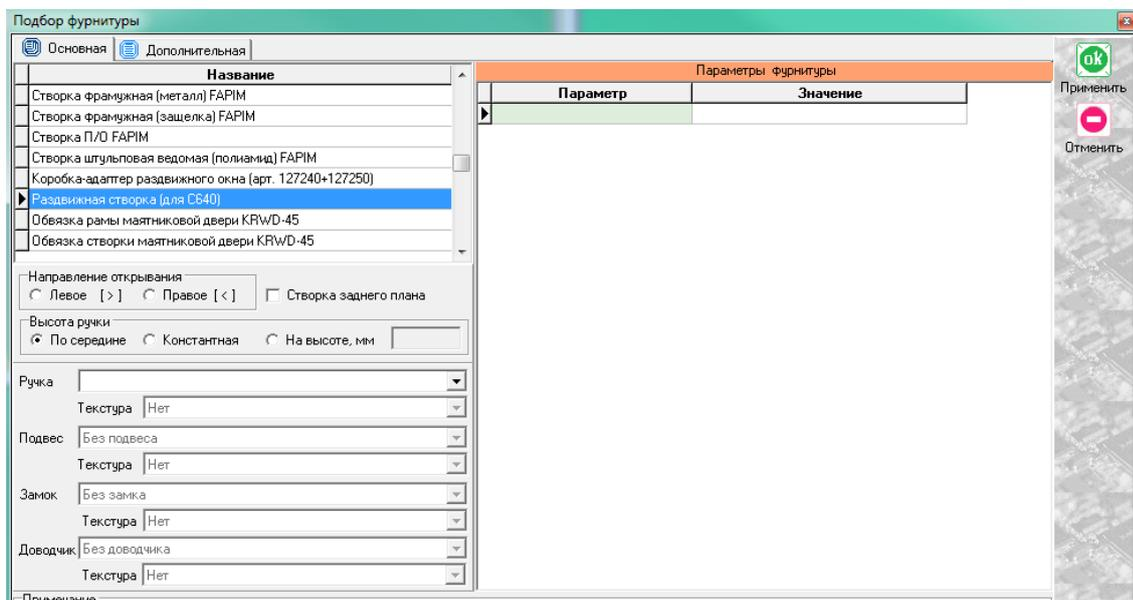
Указываем направление открывания, план расположения створки (заднего плана или переднего), ручку. После установки всех створок, конструкция должна быть следующего вида:
