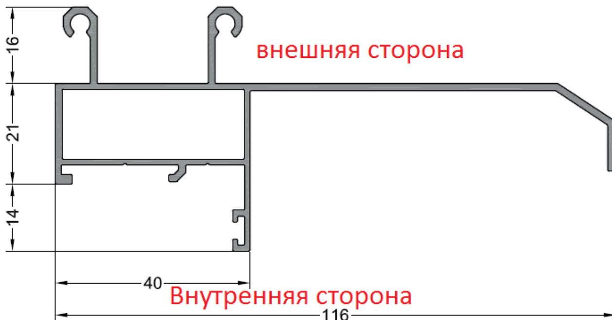
Отображение сторон в данном импосте предназначено для понимания пользователем изменять ориентацию профиля при необходимости в ходе построения конструкции. Рама-адаптер, вставляемая во внешнюю сторону данного профиля имеет следующие названия в разделе «установить створку»
