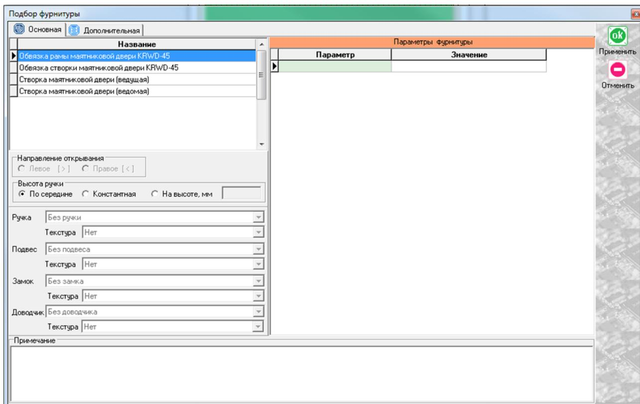
Выбираем сначала вариант «обвязка рамы маятниковой двери», после чего ждем «ОК ПРИМЕНИТЬ». Мы получили контур, необходимый для установки створок маятниковой двери, составленный из порога 127160 и профиля накладки 127110.
