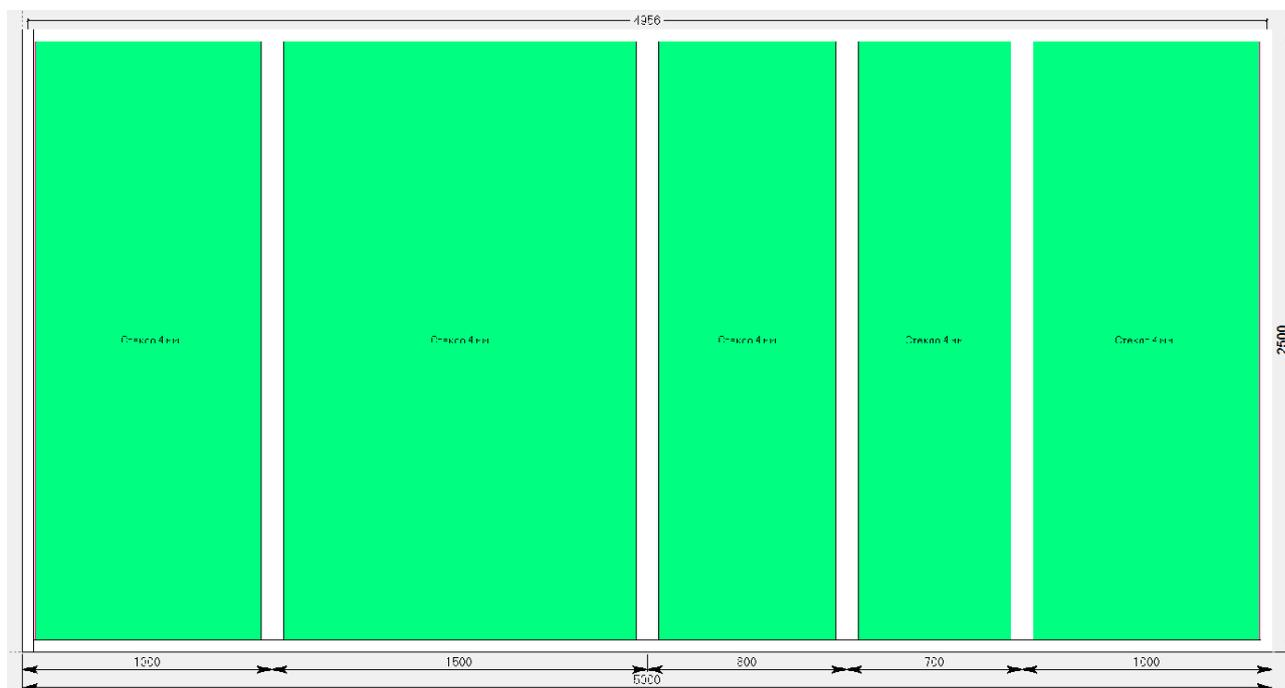
**Вариант 2:** ориентируется от левого угла коробки или проема, по умолчанию ставит одно разделение, разбивая конструкцию на две равные части. Отредактировать размер одного деления можно в окне «провести вертикальное (горизонтальное) разделение». Использование данной функции удобно в том случае, если конструкция уже имеет какой-либо элемент и нам необходимо отталкиваться от расположения данного элемента.
