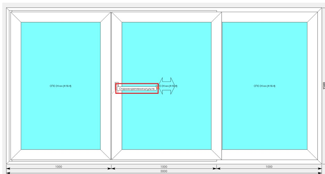
Обращаю внимание на выноску «сторона крепления шульпы». Если выбрать шульп вместе с частью створки, прилегающей к нему, а затем вызвать контекстное меню и зайти в параметр «варианты соединения», можно посмотреть эскиз узла и расположение оси, по которой программа
