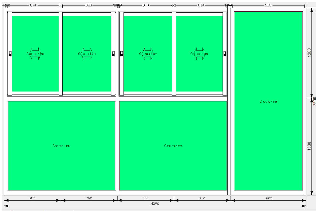
Теперь, выбрав два сопряженных профиля стойки можно вызвать контекстное меню и зайти в параметр «**варианты соединения**», поменяв соединение, на любое, возможное соединение с углом, опираясь на информацию каталога.
