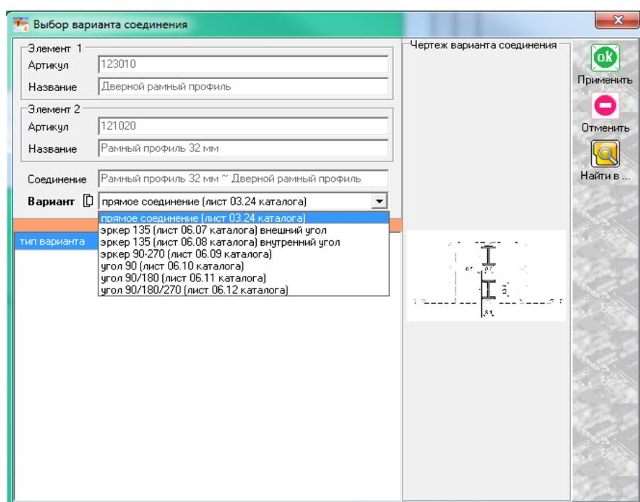
Здесь обозначены элементы, входящие в состав соединения, возможные варианты соединений (можно менять вручную) и миниатюры данного соединения.
