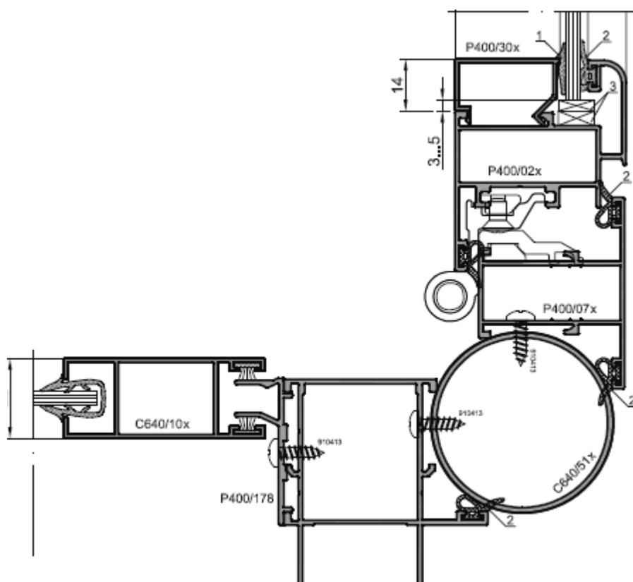
В данных соединениях профили P400/165 и C640/51 являются эркерами. Для их установки, нарисуем заготовку 2000мм шириной и 2000мм высотой, выделим верхний или нижний горизонтальный элемент и нажмем иконку
