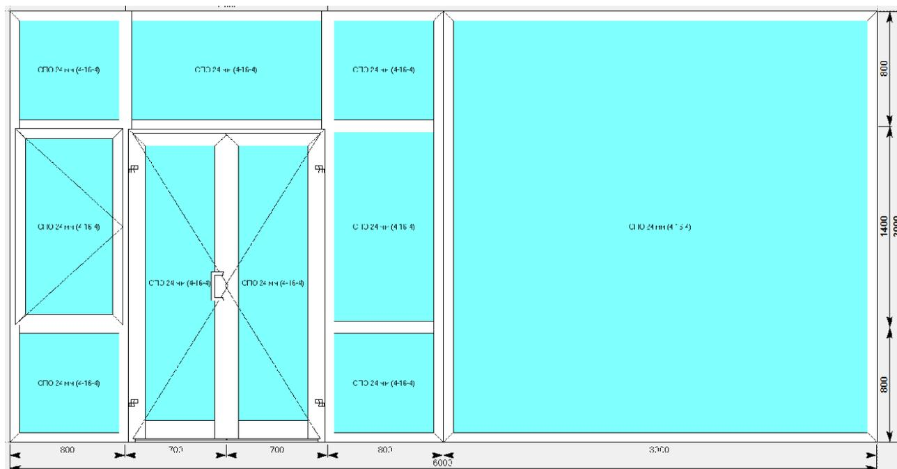
Для того, чтобы уменьшить размер правого блока, необходимо нажать левой кнопкой мыши на общий размер всего витража и отредактировать его, либо выделить крайнюю правую стойку и отодвинуть ее влево. Делается это следующим образом, при выделении стойки, появляются так называемые «ручки элемента», как показано на рисунке
