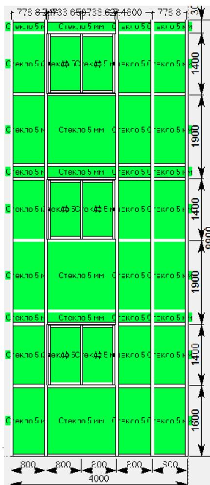
Горизонтальные импосты под окнами могут быть усиленными и выполнять роль поручня (исключительно в случае стоек с пилоном внутрь). Теперь установим вертикальные импосты в глухих областях над и под окнами, используя иконку
