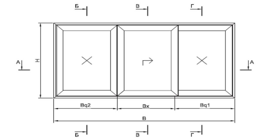
Выбираем «новое изделие», проставляем габариты (например 3000мм x 1500мм/ширина x высота). Данное изделие будет иметь штульповое соединение створок и соединение внахлест. Соединение створок внахлест происходит аналогично раздвижной системе С640, с применением @импост3.
