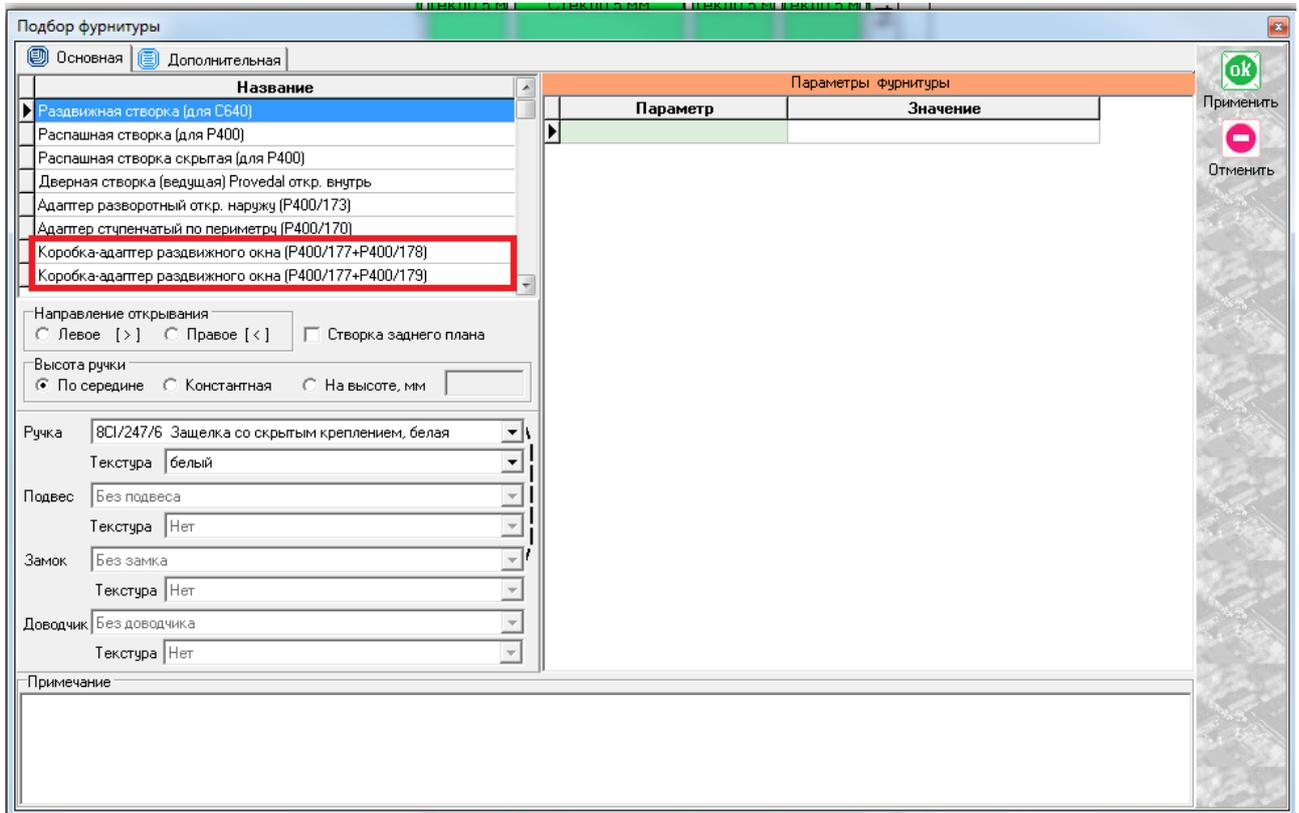
Учитывая установленные стойки P400/142 импостового типа с двух сторон от раздвижных окон, можно выбрать вариант P400/177+P400/179. После установки адаптеров, в конструкции будут выделены элементы желтыми и красными линиями, как показано ниже:
