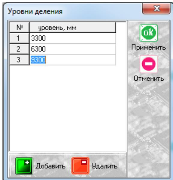
Обращаю внимание, что каждая последующая отметка деления витража (например в качестве крепления к плите перекрытию) вносится как размер от низа конструкции.
