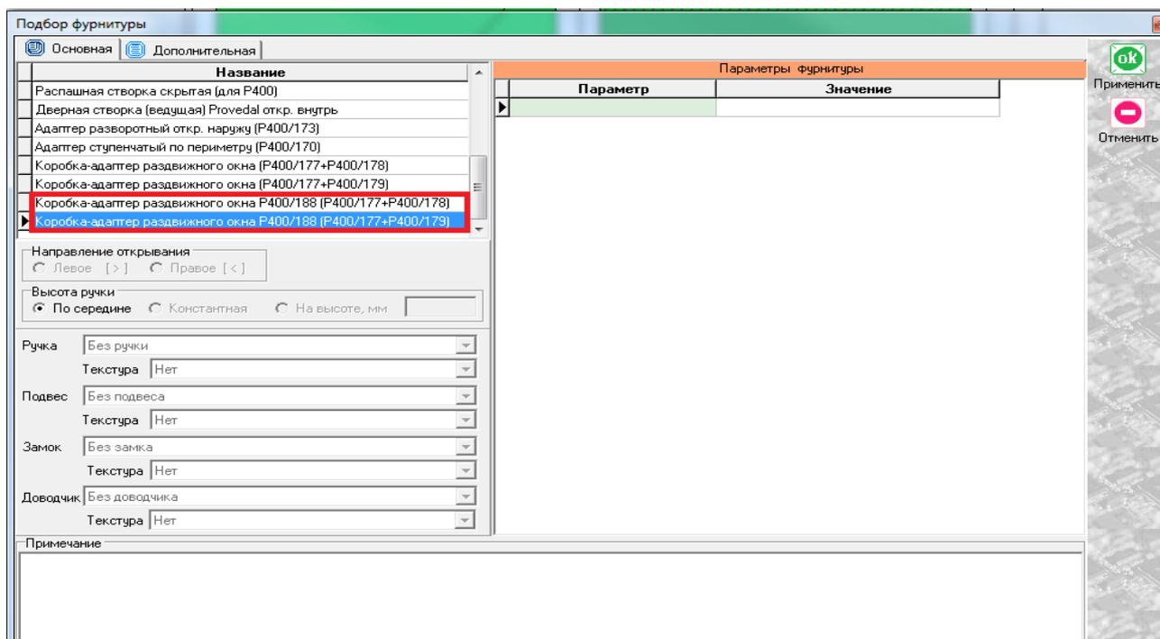
Так же, в дереве подсистем Раздв С640+комплекс Р400 появились готовые типовые изделия, предназначенные к установке конкретно под данный профиль (в названии типового изделия они подписаны «к ригелю Р400/188»). Кроме того, типовые изделия расширены усиленными створками раздвижной системы, а в режиме проектирования основной системы Р400 комплексная стало возможным использовать артикулы створок усиленных С640/11У и С640/10У:
