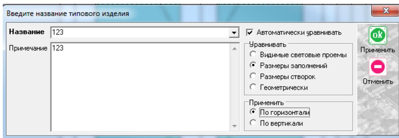
В названии я указал «123». Пункты уравнивания являются обязательными для заполнения, однако всегда могут быть отредактированы в уже вставленном изделии. В данном случае мое выравнивание обозначает, что какой бы ширины не был проем, створки будут уравнены по ширинам заполнений. Нажимаем «ОК ПРИМЕНИТЬ» и выходим из изделия без сохранения.
