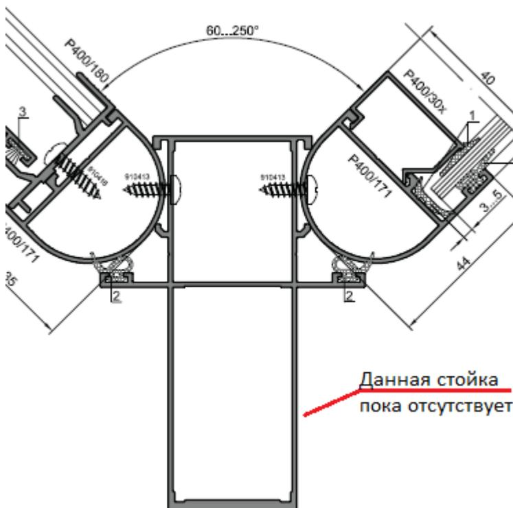
На данном эскизе нарисованы поворотные профили P400/171 и несущая стойка между ними P400/112. Эту стойку вместе с крепежными элементами мы и предусмотрим в разделе комплектация.
