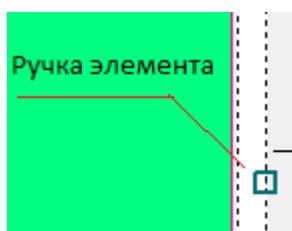
Нажимаем левой кнопкой мыши на центральную ручку (для равномерного перемещения всей стойки), появляется окно «перемещения профиля».
