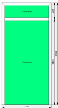
Далее необходимо дополнить раму оконную дверным адаптером 127190 или 127200, в зависимости от типа открывания. Выделяем нижнее заполнение и нажимаем иконку
