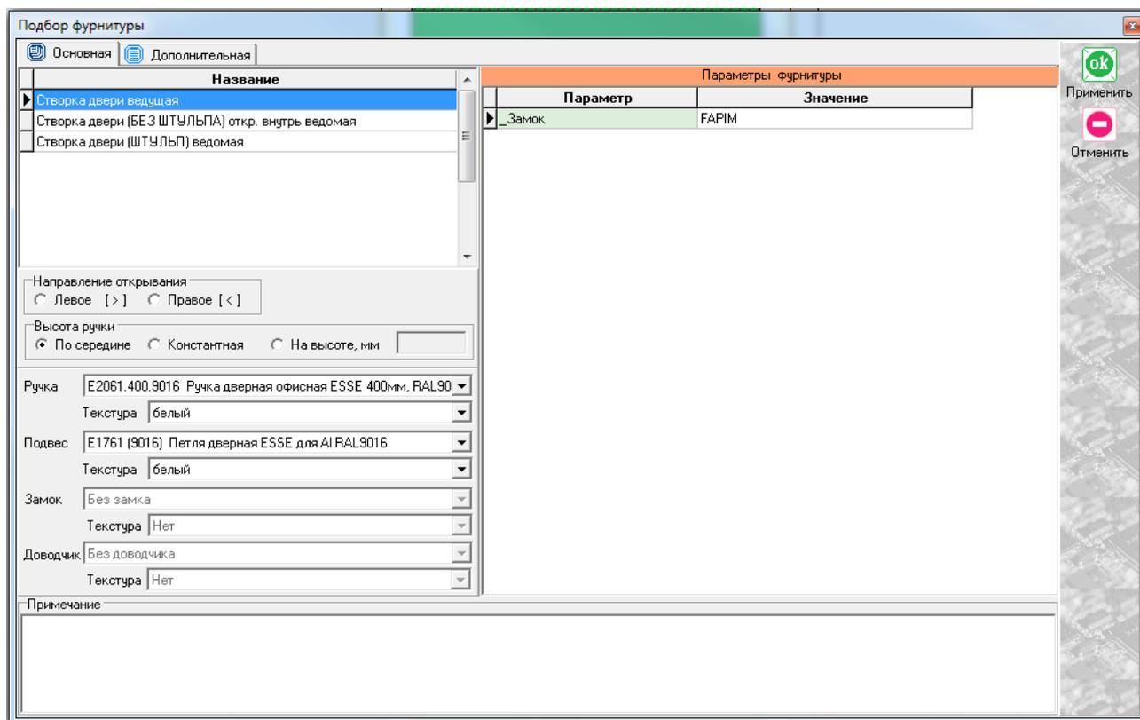
В случае с одностворчатой дверью выбираем единственно возможный вариант «створка двери ведущая», после чего соглашаемся с параметрами по умолчанию или приведем их к необходимым значениям. Получаем эскиз следующего вида:
