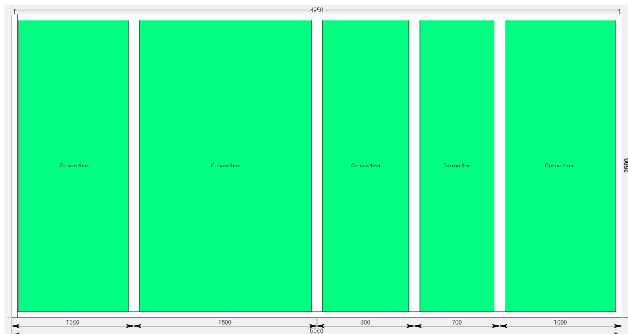
**Вариант 2:** ориентируется от левого угла коробки или проема, по умолчанию ставит одно разделение, разбивая конструкцию на две равные части. Отредактировать размер одного деления можно в окне «провести вертикальное (горизонтальное) разделение». Использование данной функции удобно в том случае, если конструкция уже имеет какой-либо элемент и нам необходимо отталкиваться от расположения данного элемента.
