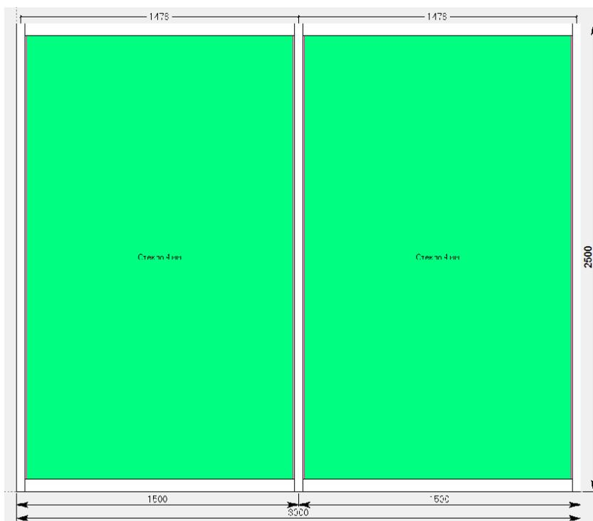
Обратите внимание на соединение центральной стойки с профилями рамы. Выделив стойку и нажав правую кнопку мыши для вызова контекстного меню, можно зайти в составы элемента и добавить, при необходимости, так называемые «башмаки» - вставка соединительная для дальнейшего крепления к монтажным пластинам в процессе монтажа.
