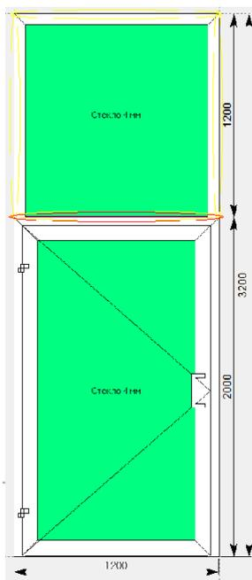
На эскизе конструкция помечается желтыми и красными линиями. Т.к. верхний наставочный витраж состоит из тех же профилей, что и конструкция под ним (низ горизонт-профиль порога, остальные профили периметра-профили рамы дверной 123010), то делаем вывод, что желтыми линиями выделяются места, где невозможна установка стекла в профиль, а красной линией отмечается отсутствующее соединение (не предусмотренное каталогом).
