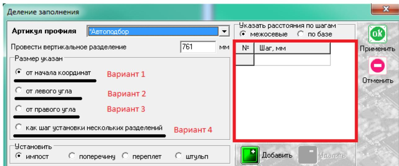
**Вариант 1:** по умолчанию ставит одно разделение, разбивая конструкцию на две равные части. Отредактировать размер одного деления можно в окне «провести вертикальное (горизонтальное) разделение». Начало координат по осям X и Y расположено в левом нижнем углу конструкции. Если с данным вариантом использовать окно «шаг» и задать шаги разной длины, например 1000мм, 1500мм, 800мм, 700мм и ОСТАТОК (который не вписывается в таблицу), получим конструкцию вида:
