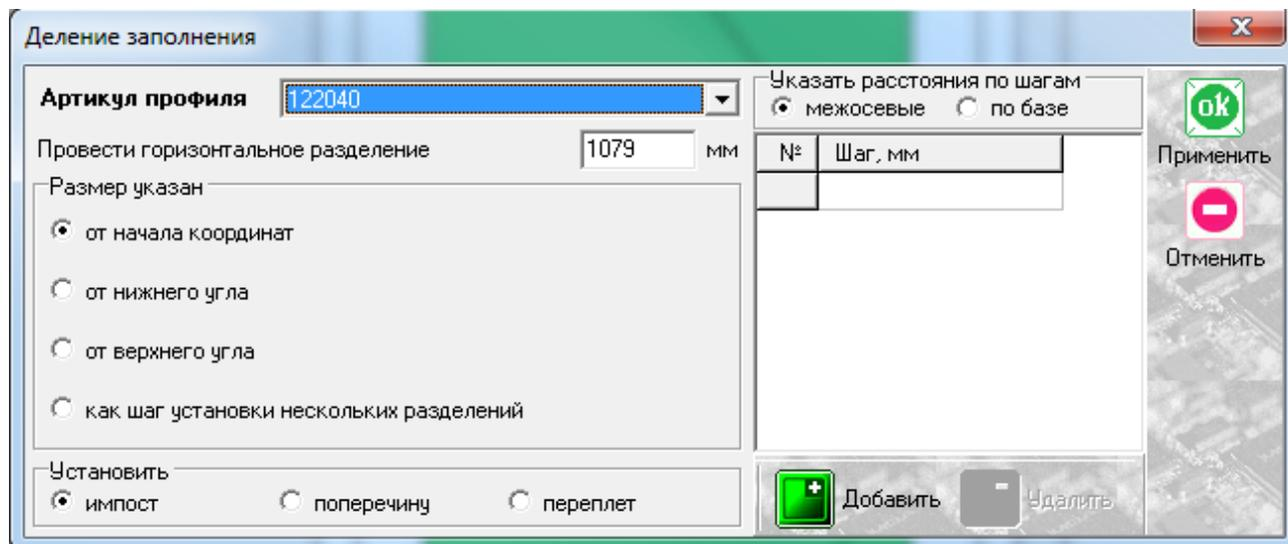
Заполняем графу наименование артикула. После этого осталось указать высоту, на которой расположен импост. Есть несколько вариантов указания размеров, но в данном конкретном случае достаточно использовать вариант «от начала координат», который установлен по умолчанию, предварительно указав размер от пола до центральной оси импоста в окне «провести горизонтальное разделение». Остальные варианты мы рассмотрим более подробно в разделе «Витражи конструкторская».
