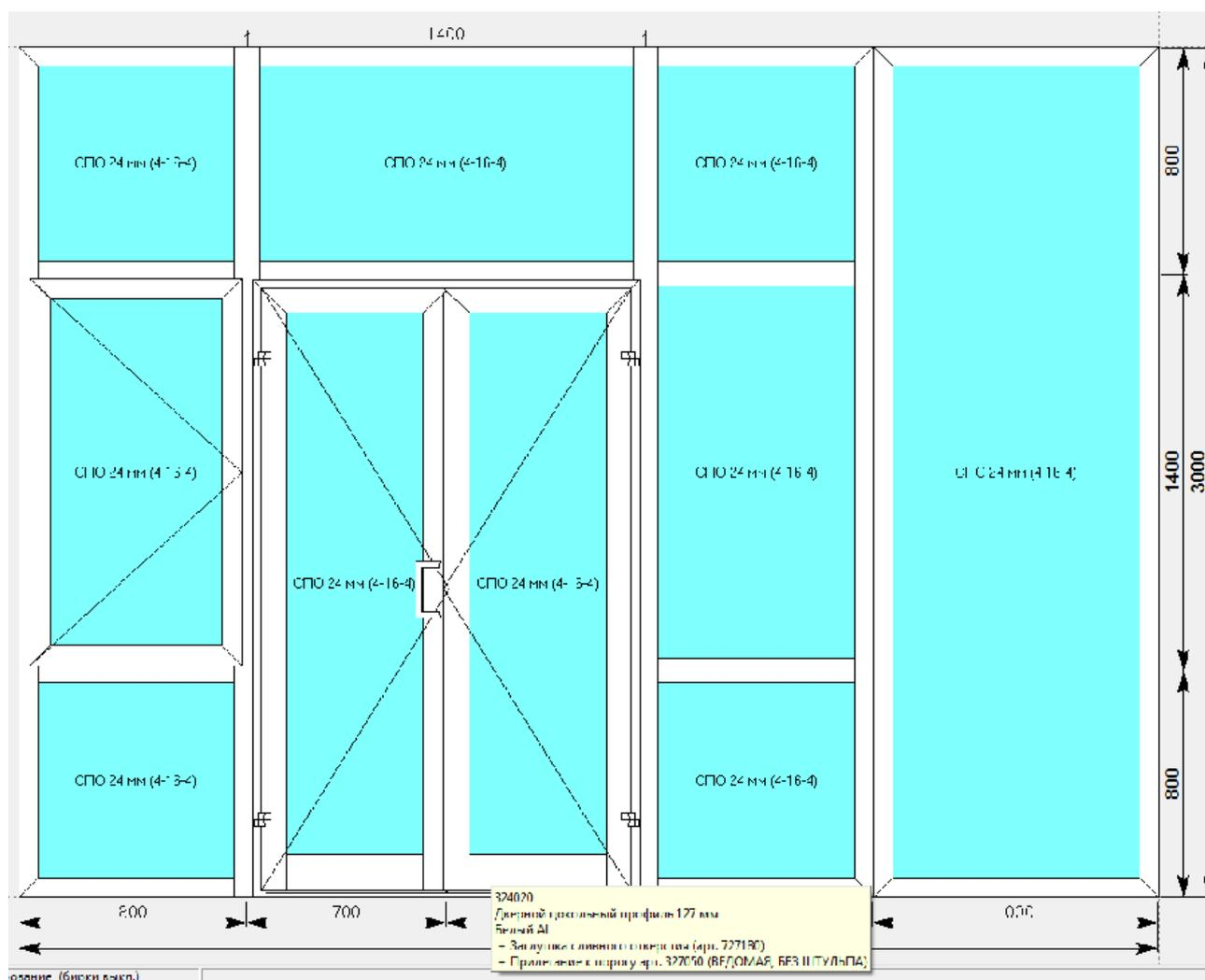
Теперь, выбрав два сопряженных профиля стойки можно вызвать контекстное меню и зайти в параметр «[варианты соединения](#)», поменяв соединение, на любое, возможное соединение с углом, опираясь на информацию каталога.
