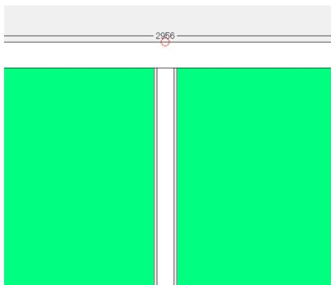
Минусом данного варианта является то, что наша стойка не разбила горизонтальные рамы. Поэтому придется прибегнуть к дополнительному действию – выделяем один из горизонтальных элементов и стойку и нажимаем иконку
