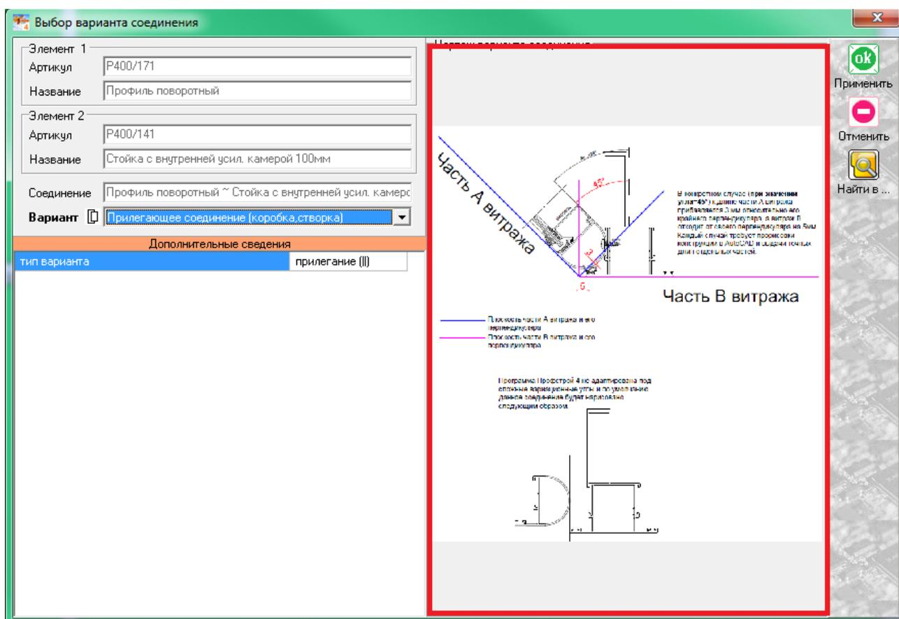
Внимательно рассматриваем параметры соединения, до полного понимания какие отметки в замерах должен дать замерщик и как правильно занести в программу изделие должен конструктор.
