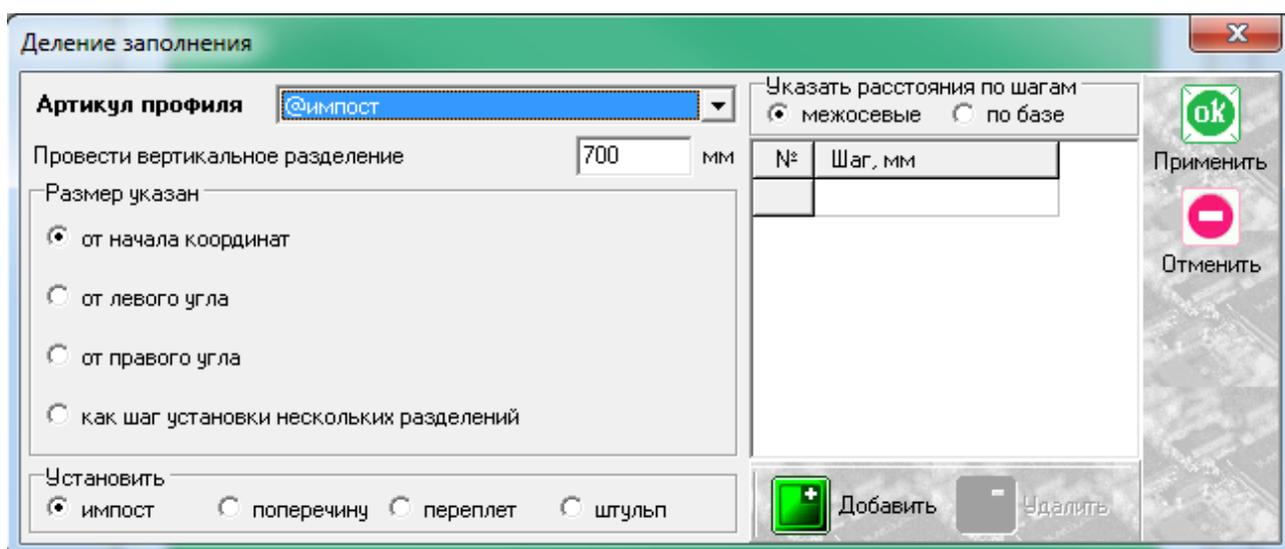
С функцией деления заполнения мы сталкивались ранее на примере горизонтального деления, таблица содержит похожие графы для заполнения, с единственным отличием – деление осуществляется вертикальной линией и отсчет размера для установки вертикального разделения происходит слева направо,
