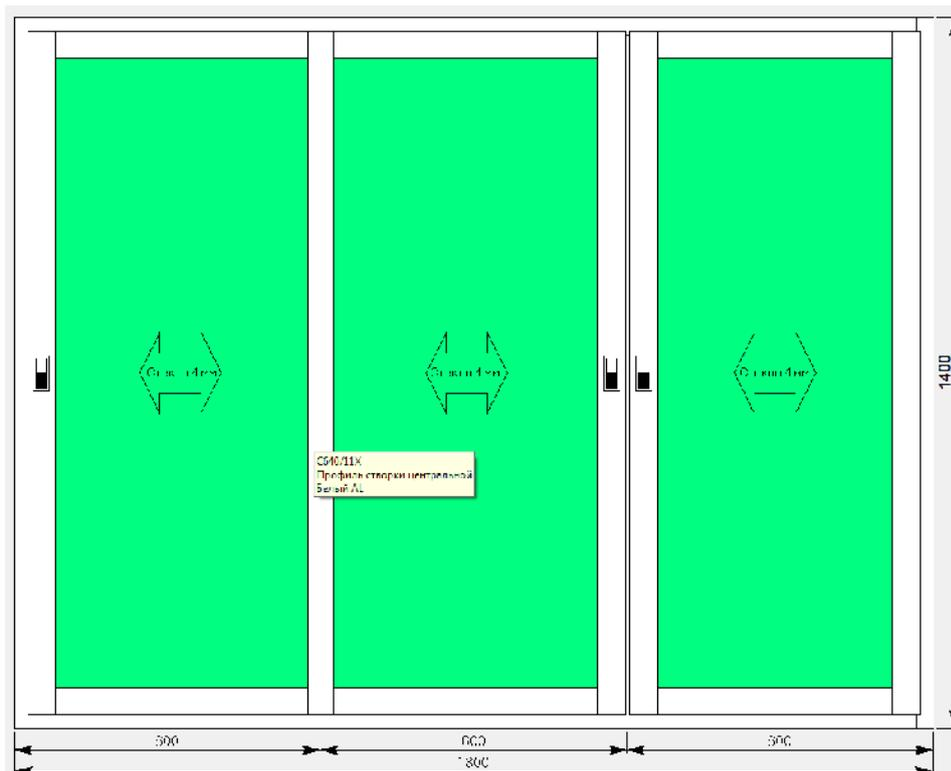
В случае необходимости, меняем артикулы профилей створок через «свойства элементов». В данном разделе можно добавлять распашные рамы и створки через соединитель в случае проектирования лоджий. (через иконку
