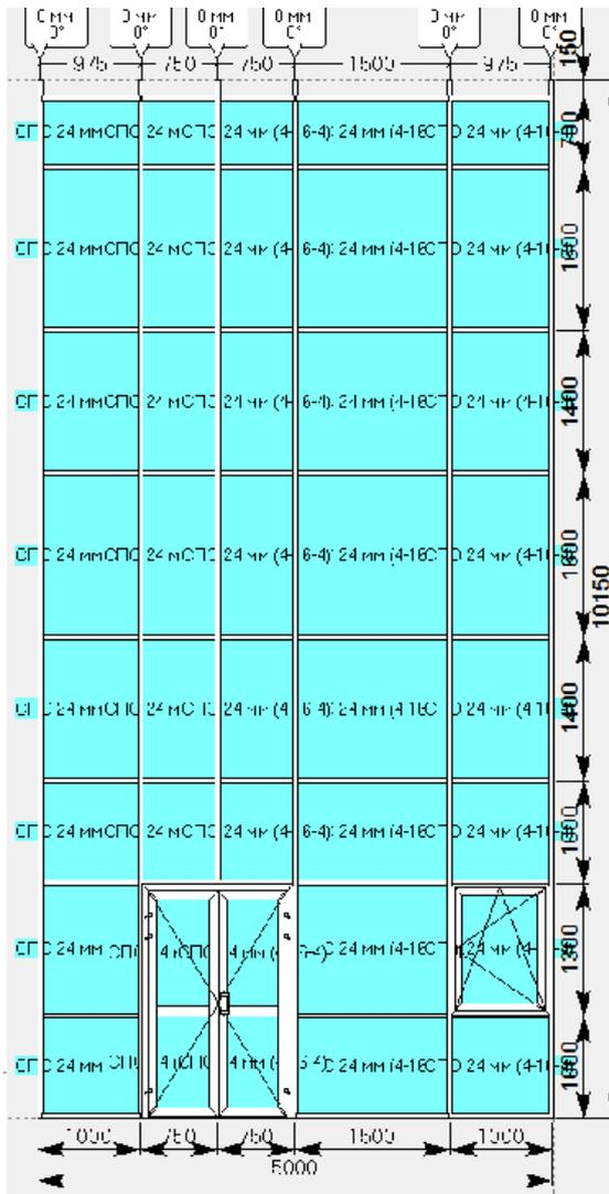
Если в какой-либо конструкции необходим проем, например под автоматическую дверь, достаточно просто удалить ригели в данном проеме кнопкой «delete» на клавиатуре, либо поднять нижний ригель, предварительно выделив его (процесс подробно описан в системе KRWD 45/витражи конструкторская). Как вариант, можно попробовать это сделать в нашей конструкции, а в качестве проема предусмотреть место между окном и дверью.
