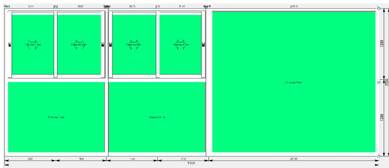
Для того, чтобы уменьшить размер правого блока, необходимо нажать левой кнопкой мыши на общий размер всего витража и отредактировать его, либо выделить крайнюю правую стойку и отодвинуть ее влево. Делается это следующим образом, при выделении стойки, появляются так называемые «ручки элемента», как показано на рисунке
