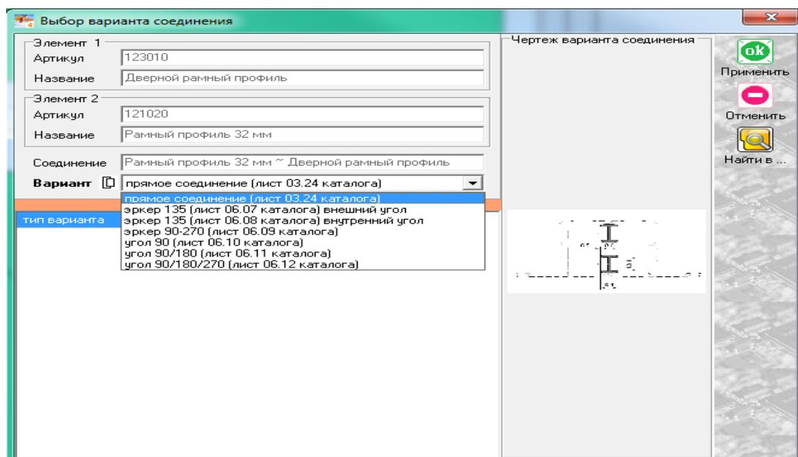
Здесь обозначены элементы, входящие в состав соединения, возможные варианты соединений (можно менять вручную) и миниатюры данного соединения.
