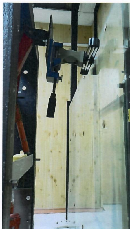
Фото 1, 2. Приложение горизонтальной нагрузки 0,5 кН.
