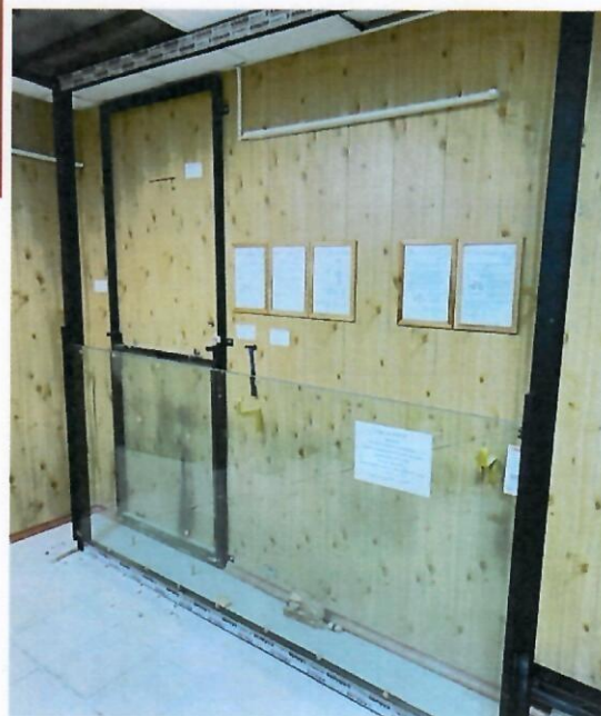
Фото 3, 4. Образец рег. № 4953-25. При воздействии нагрузки конструкция не имеет видимых деформаций, остаточная деформация отсутствует, ограждающий экран не выпал.
