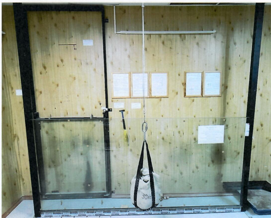
Фото 8. Общий вид после удара (точка 2), высота падения 1200мм. Образец не имеет видимых разрушений. Целостность образца не нарушена, остекление не выпало.
