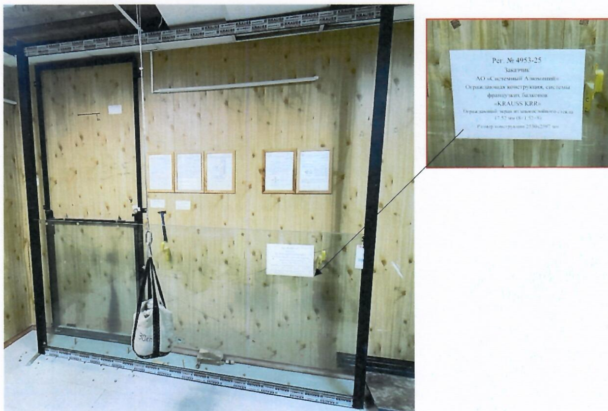
Фото 5. Общий вид стенда для испытаний ограждающей светопрозрачной конструкции системы французских балконов «KRAUSS KRR» с ограждающим экраном из многослойного стекла толщиной 17,52мм (8+1,52+8) к динамической нагрузке (удар мягким неупругим телом массой 30кг). Фрагмент конструкции размером 2530х2597 мм регистрационный номер ИЛ 4953-25
