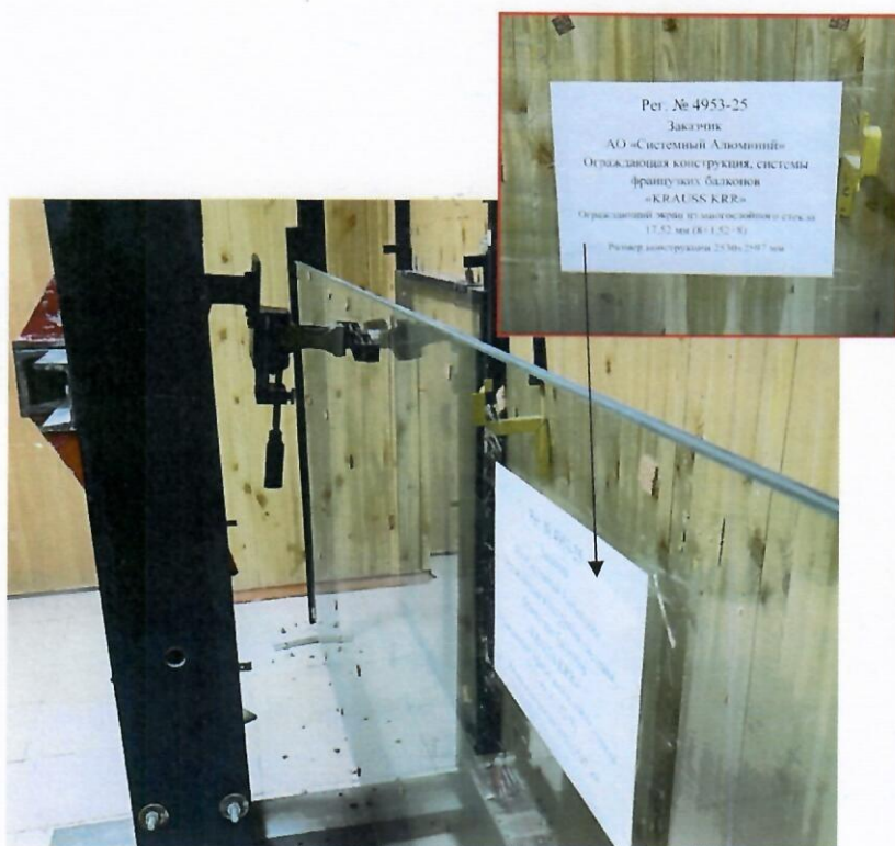
Фото 1, 2. Приложение горизонтальной нагрузки 0,5 кН.
