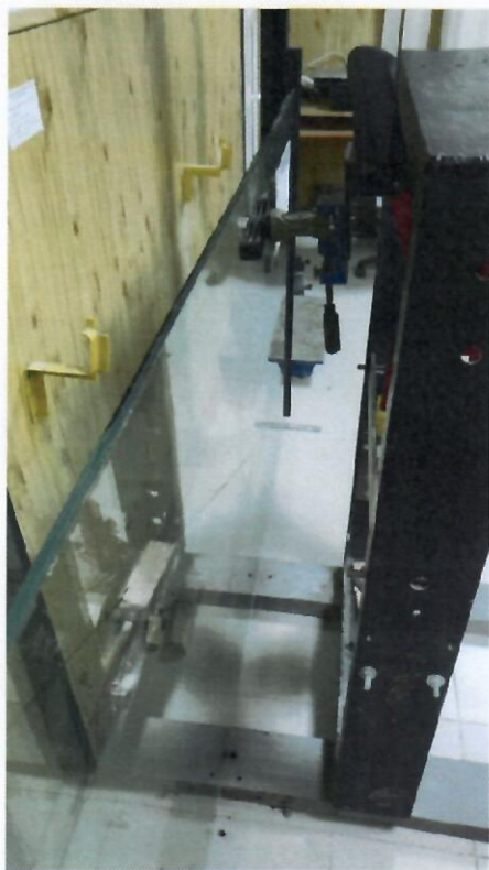
Фото 1, 2. Приложение горизонтальной нагрузки 0,5 кН.
