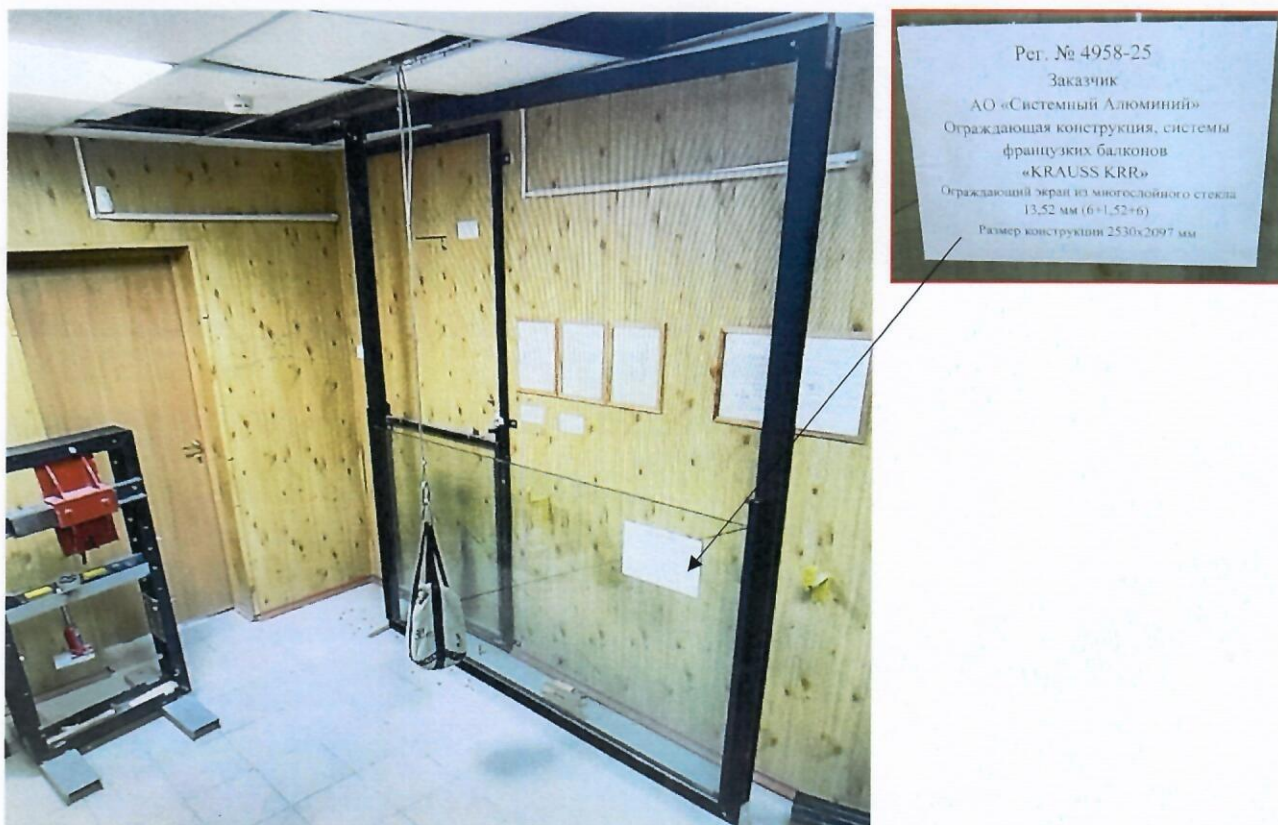
Фото 5. Общий вид стенда для испытаний ограждающей светопрозрачной конструкции системы французских балконов «KRAUSS KRR» с ограждающим экраном из многослойного стекла толщиной 13,52мм (6+1,52+6) к динамической нагрузке (удар мягким неупругим телом массой 30кг). Фрагмент конструкции размером 2530x2097 мм регистрационный номер ИЛ 4958-25
