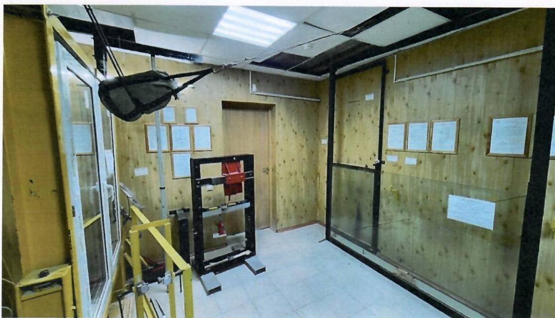
Фото 7. Общий вид стенда для испытаний ограждающей светопрозрачной конструкции системы французских балконов «KRAUSS KRR» с ограждающим экраном из многослойного стекла толщиной 13,52мм (6+1,52+6) к динамической нагрузке (удар мягким неупругим телом массой 30кг, высота падения мешка 1200 мм). Фрагмент конструкции размером 2530x2097 мм регистрационный номер ИЛ 4958-25
