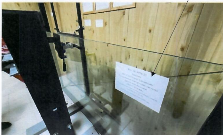
Фото 3, 4. Образец рег. № 4958-25. При воздействии нагрузки конструкция не имеет видимых деформаций, остаточная деформация отсутствует, ограждающий экран не выпал.
