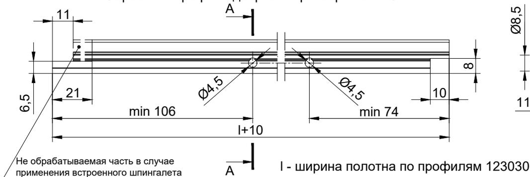
Для крепления дверного притвора винтами BC 3,9\*22 DIN 7982 A2 в цокольном профиле дверного полотна выполнить отверстия Ø3 мм.
