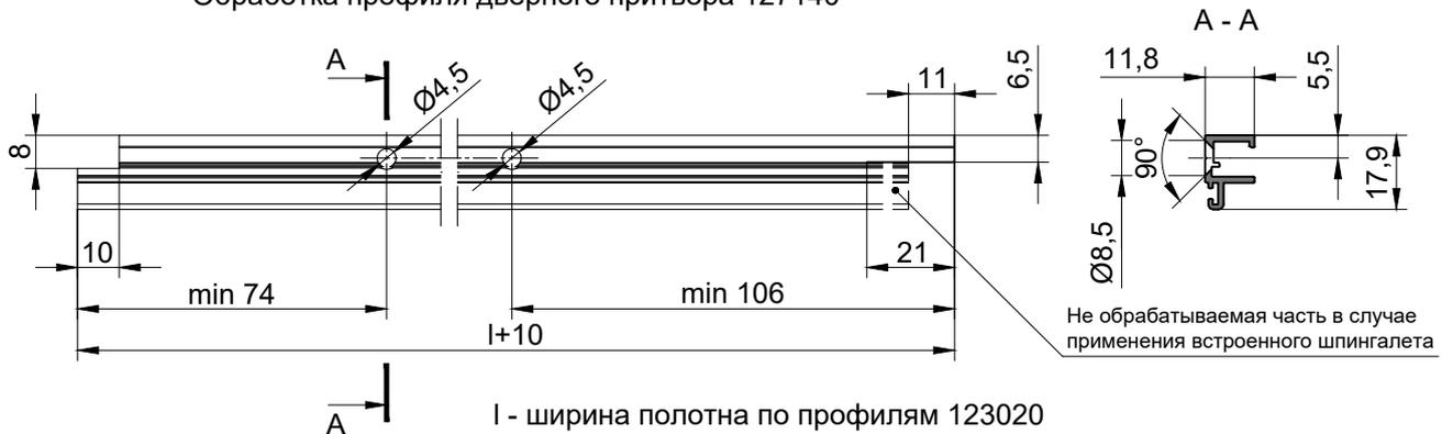
Для крепления дверного притвора винтами BC 3,9\*22 DIN 7982 A2 в цокольном профиле дверного полотна выполнить отверстия Ø3 мм.
