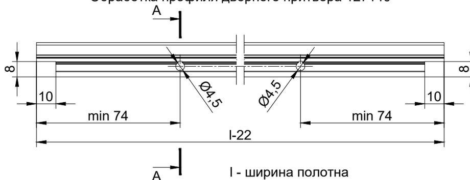
Обработка и установка профиля дверного притвора 127140
