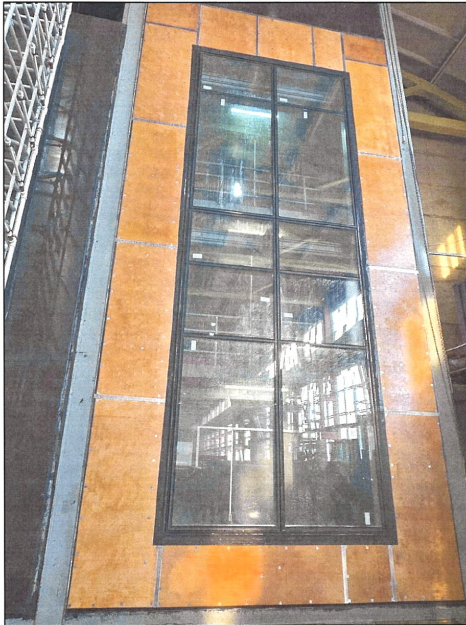
Рисунок 2 – Общий вид образца 272-25-7, установленного на испытательный Стенд, в ходе определения его воздухопроницаемости
