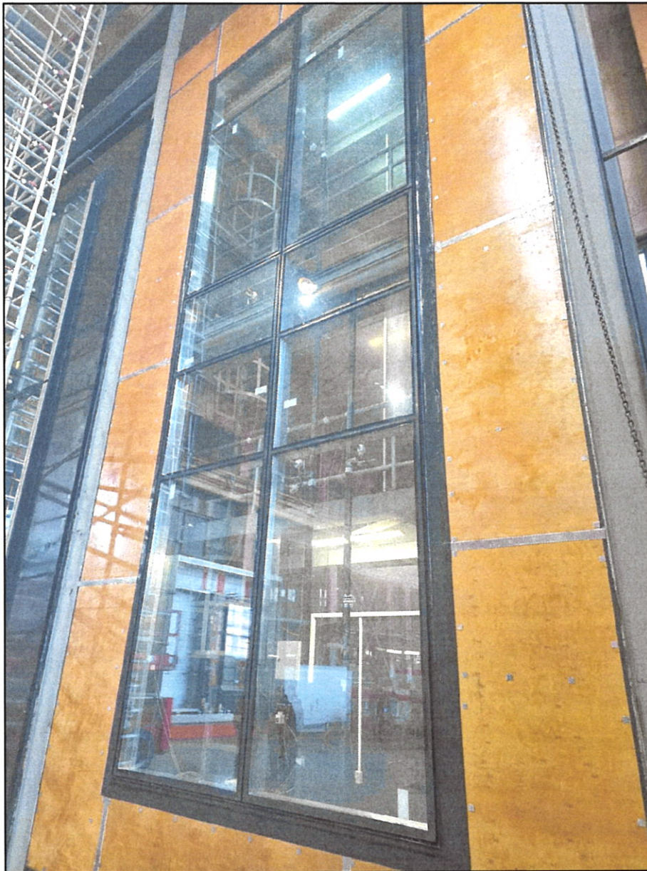
Рисунок 4 – Общий вид образца 272-25-7, установленного на испытательный Стенд, в ходе определения его сопротивления ветровым нагрузкам
